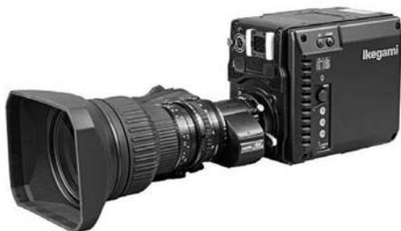
「UHK-430/435」システムカメラと同じ2/3型4K 8M Pixel CMOS 3 板式の光学系を搭載した4K マルチパーパスカメラ。ワンピースタイプのコンパクト設計のため、パンチルトシステムの外、情報カメラ用途に最適。また、HDR に対応し、ネイティブ4K とHD (4K ダウンコンバート/4K カットアウト)出力を切り替えて運用することができる。12G-SDI 出力を標準装備、オプションで3G-SDI QUAD LINK にも対応する。各種のコントロールパネルとの接続が可能。
